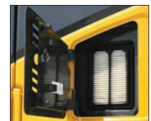
Filtro del Acondicionador de Aire Externo
